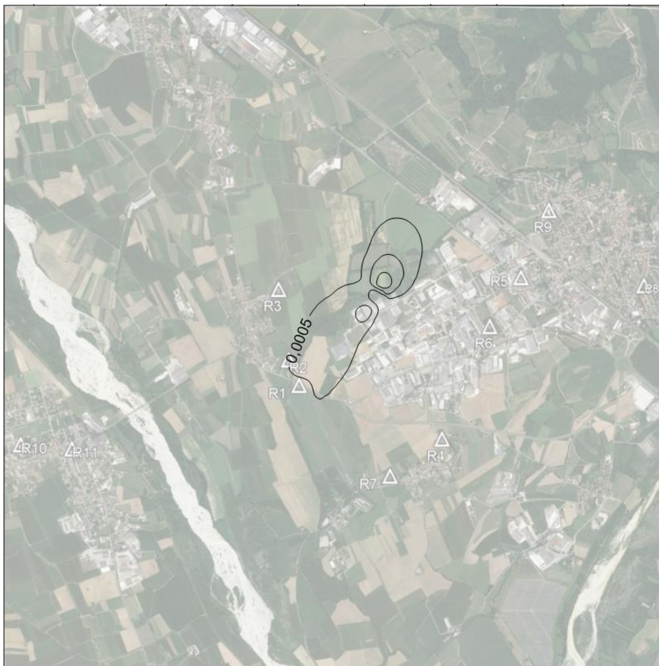
Figura 6: Diossine e Furani in ricaduta su mediazione annuale ( \text{pg}/\text{m}^3 ) – ipotesi di progetto.
